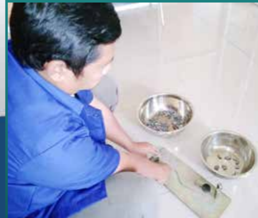
PENGUJIAN AGREGAT PIPIH LONJONG
