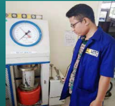
PENGUJIAN KUAT TEKAN BETON
